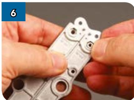
Переверните конструкцию и поместите гайку в одно из гнезд над соединительными отверстиями в деталях (LFR-15) и (LFR-16).
