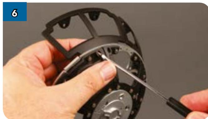
Повторите шаги 4 и 5, чтобы закрепить деталь (DF-12) ещё одним винтом с гайкой.
