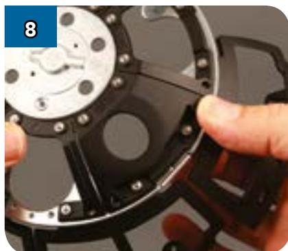
8 Плотно соедините деталь (DF-14) с готовой частью каркаса: её установочные штифты должны войти в соответствующие отверстия.
