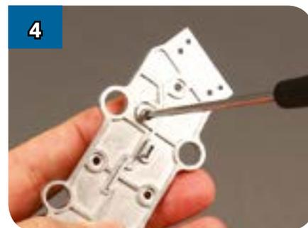
Удерживая гайку, установите винт в соединительное отверстие в детали (LFR-15) и заверните его в гайку.
