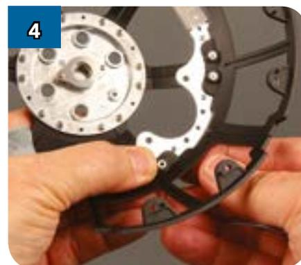
Удерживая раму (DF-12) на месте, установите гайку в шестиугольное гнездо над крепёжным отверстием.
