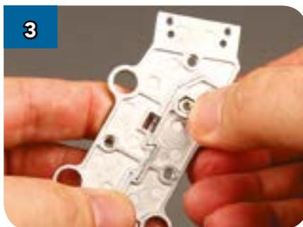
Переверните конструкцию и поместите гайку в шестиугольное гнездо над соединительным отверстием в детали (LFR-16).
