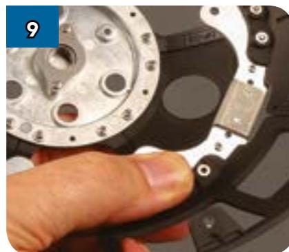
9 Удерживая раму (DF-14) на месте, установите гайку в шестиугольное гнездо над крепёжным отверстием.
