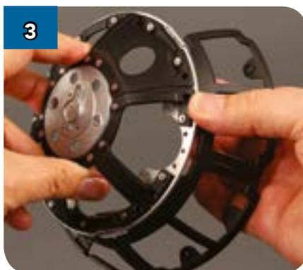
Плотно соедините деталь (DF-12) с готовой частью каркаса так, чтобы её установочные штифты вошли в соответствующие отверстия.
