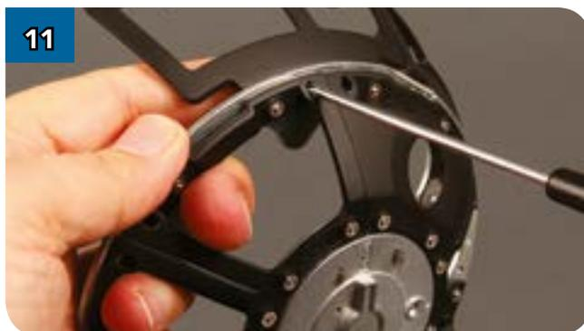
11 Повторите шаги 9 и 10, чтобы закрепить деталь (DF-14) ещё одним винтом с гайкой.
