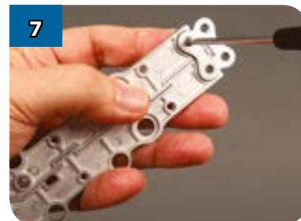
Вставьте с другой стороны конструкции винт и заверните его в гайку. Повторите шаги 6 и 7, чтобы закрепить конструкцию ещё одним винтом с гайкой.
